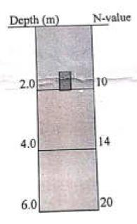
Ist Undisturbed Sample in Borehole LEGEND:
